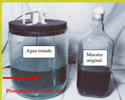
Figura N° 2. Biorreactor de tanque agitado, en donde se llevó a cabo la biorremediación de cromo VII por Pseudomonas sp , en donde se muestra la variación del color del agua residual de azul oscuro a verde y la precipitación del cromo III.
