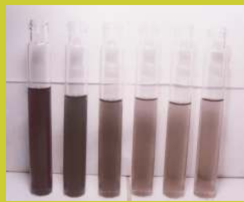
Figura N° 3. Variación del aspecto físico del agua residual de curtiembre durante la biorremediación con Pseudomonas sp , en biorreactor de tanque agitado.
