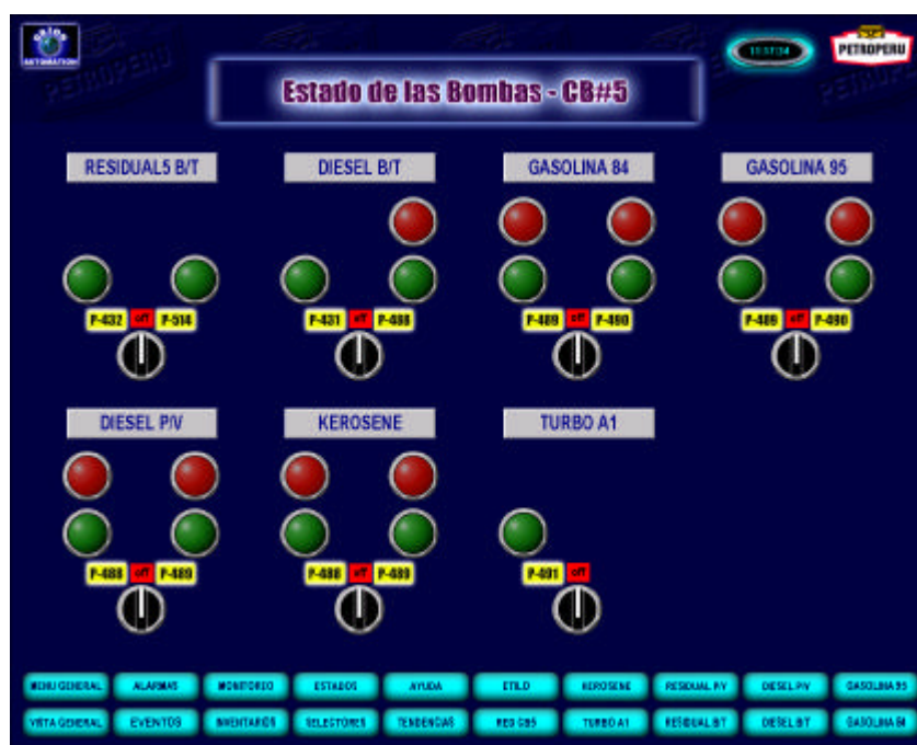
Fig. 8.8.- Pantalla Estado de Bombas del Sistema Supervisor.
