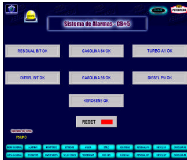
Fig. 8.3.- Pantalla Alarmas del Sistema Supervisor.
