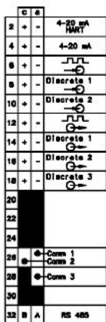
Fig. 6.6.- Bloque de terminales del controlador de Batch Discreto 3300.
