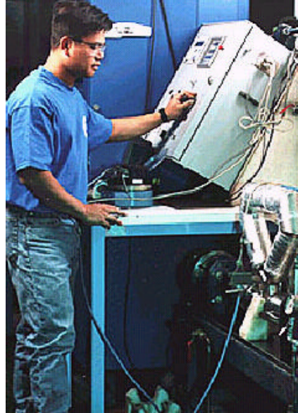
Fig. A.20.- Calibración de medidor Coriolis.
