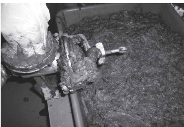
Figura 4. Proceso de molienda de cáscaras de banana maduro, utilizadas en esta investigación.
