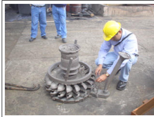
Figura N° 18: Inspección Visual al Rodete Pelton después de Colada.
