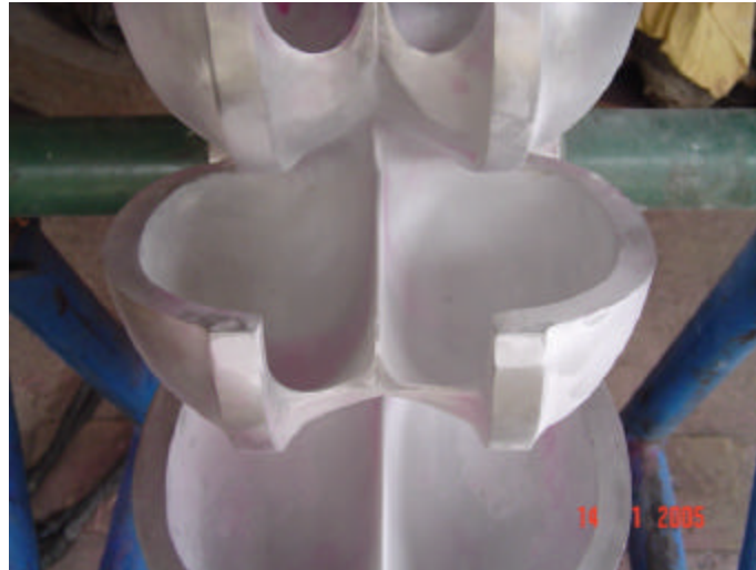
Figura N° 21: Inspección con Tintes Penetrantes luego del Pulido Final.
