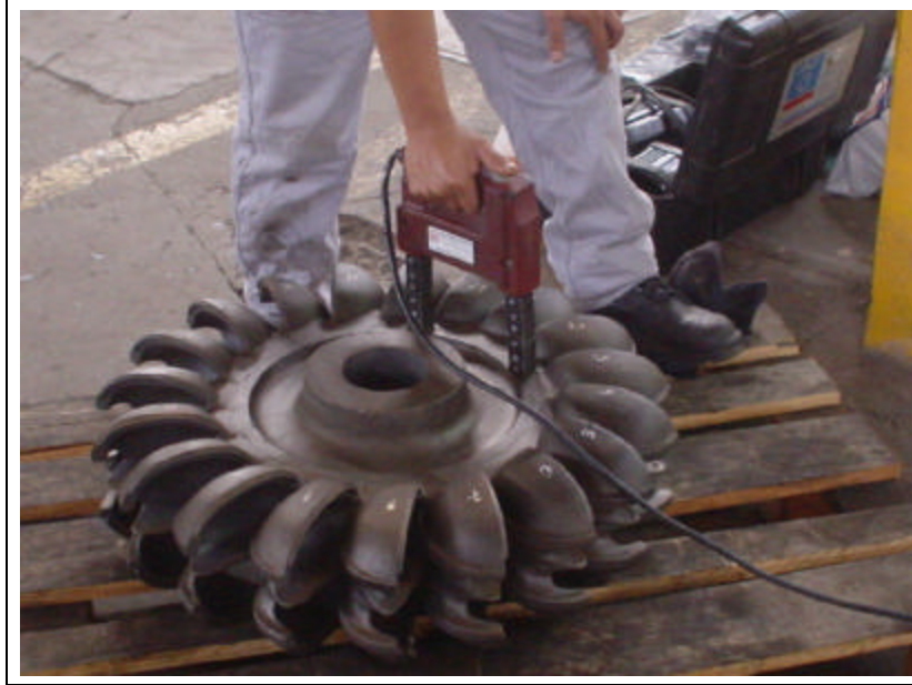
Figura N° 20: Inspección con Partículas Magnéticas después de la Fundición.
