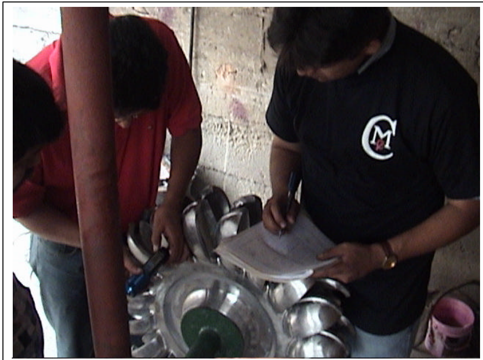
Figura N° 23: Control de Dureza del rodete Pelton.
