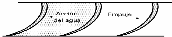
Fig. 3.3 Turbina de Reacción
