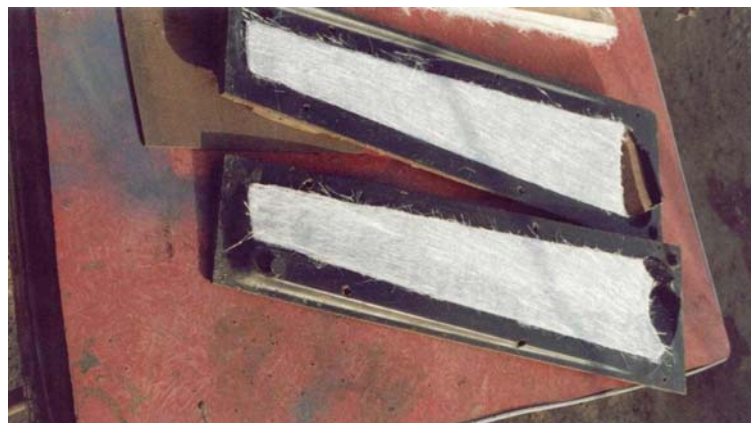
Fig. 6.4 Preparación del molde con fibra de vidrio
