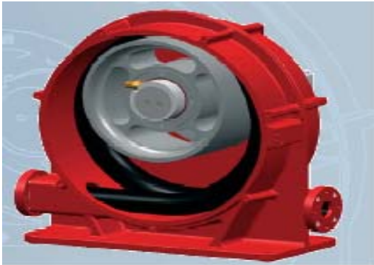
Bombas Peristálticas dibujo obtenido de la compañía Vanton
