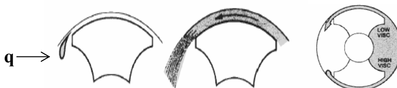
En la figura se puede apreciar el resbalamiento “q” obtenido de Waukesha Cherry-Burrell. Engineering Manual.
