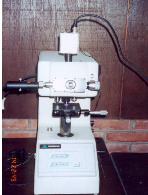
FOTO 04 MICRODURÓMETRO REALIZANDO LA INDENTACIÓN EN UN ESPECÍMEN
