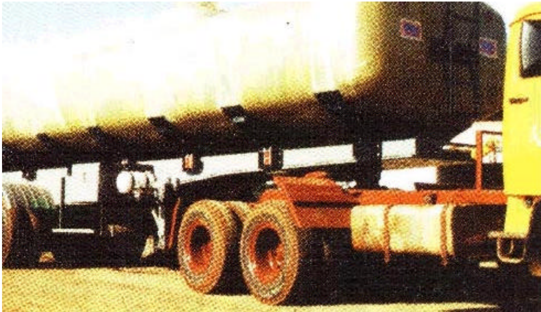
FIGURA 5.1 TANQUE SEMIELIPTICO TRANSPORTE DE VINAZA Fuente: DERAKANE NEWS
