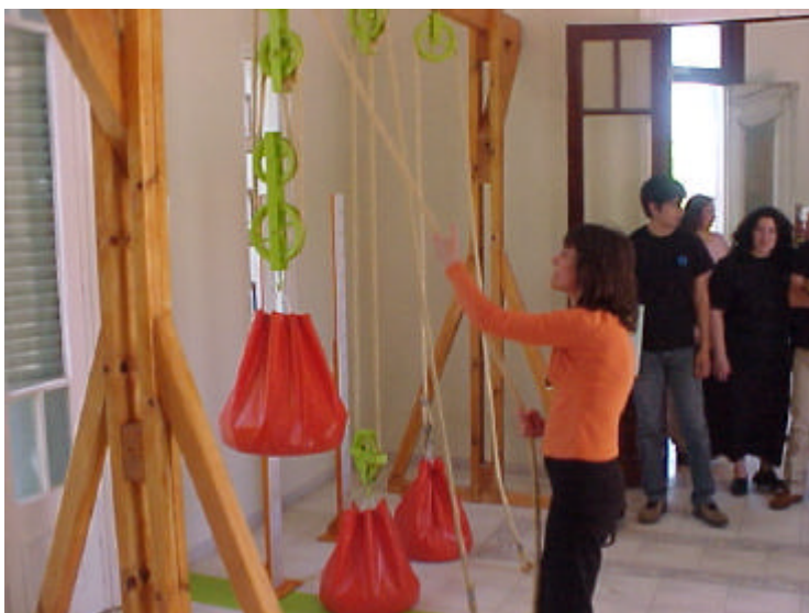
Figura 5 Dispositivo de Aparejos, sistemas de poleas, en diferentes situaciones, accionado por los visitantes, en el cual se muestra el concepto de trabajo mecánico.
