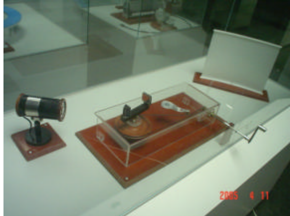
Figura 16. Experimento de Dispersión de la luz. Se observa: Izquierda, la fuente de luz; centro, el sistema mecánico para permutar espejo por prisma y a la derecha, una pantalla para proyectar el efecto.
