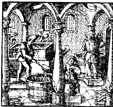
Fig. 11 Recipiente, en que se mezclan sosa con orina De: Georgius Agrícola, De re metálica. Basel, 1556
