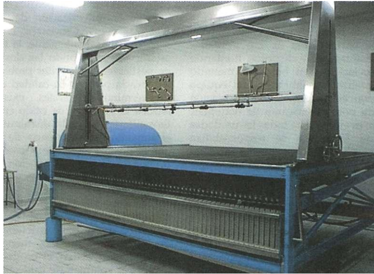
FIGURA 1.- Mesa de ensayo para análisis de la distribución volumétrica transversal de boquillas de pulverización.
